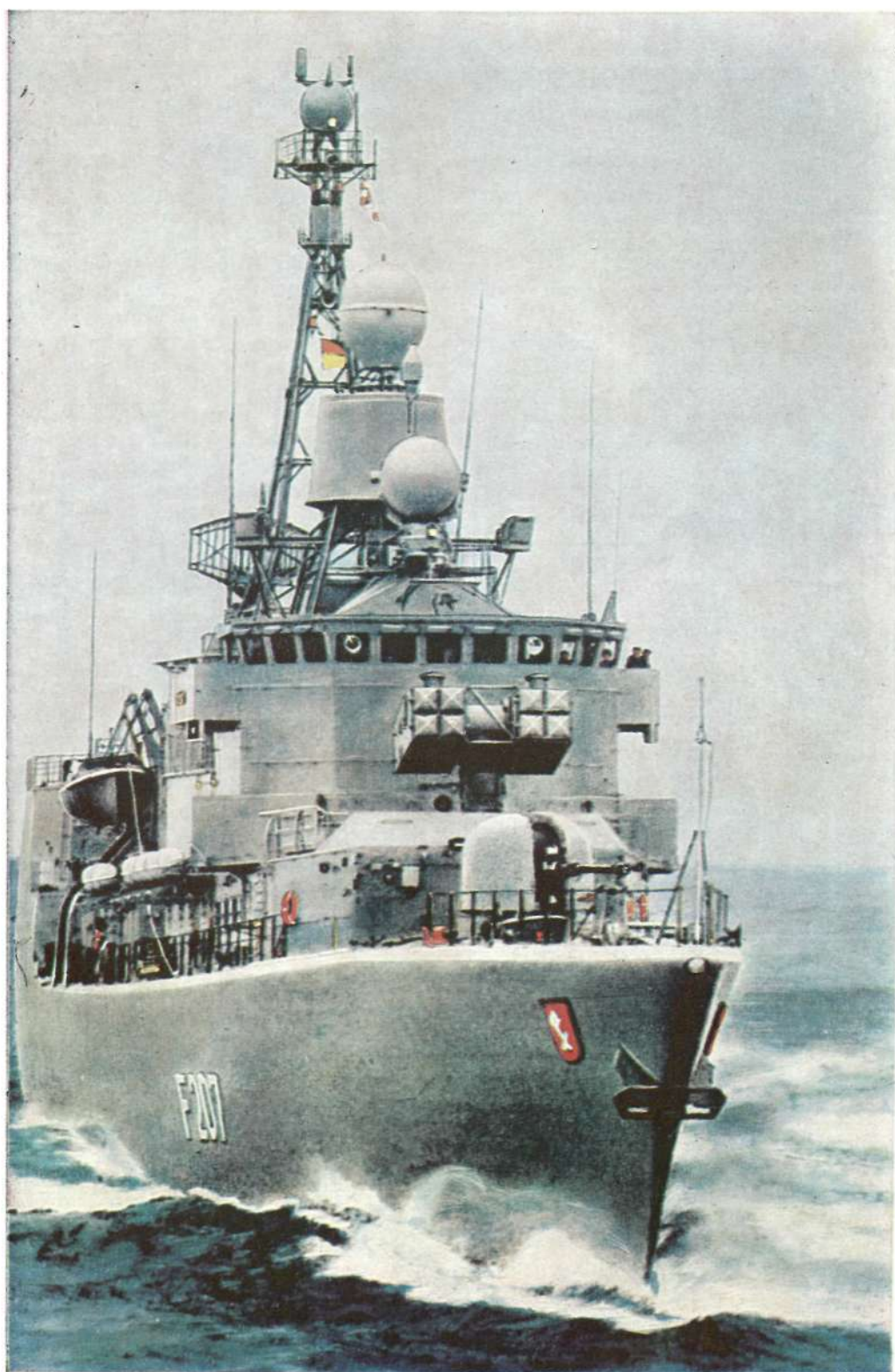
ЗАПАДНОГЕРМАНСКИЙ ФРЕГАТ УРО «БРЕМЕН». Его стандартное водоизмещение 2900 т, полное 3800 т; длина 130,5 м, ширина 14,4 м, осадка 6 м; мощность энергетической установки 51 600 л. с.; наибольшая скорость хода 30 уз; дальность плавания 4000 миль при скорости 18 уз; вооружение: системы УРО «Гарпун» и ЗУРО «НАТО-Си Спарроу», ЗРК ближнего действия ASMD, 76-мм башенная артиллерия «ОТО Мелара», два двухтрубных торпедных аппарата Mk32, два противолодочных вертолета «Линкс». Радиоэлектронное вооружение — боевая информационно-управляющая система SATIR-3, РЛС системы управления стрельбой WM-25, двухкоординатная РЛС обнаружения воздушных целей DA-08, РЛС подсветки и сопровождения воздушных целей «Стир», навигационные РЛС «Декна» Mk21 и 3RM-20, ГАС DSQS-21BZ, станция радиоэлектронного подавления FL-1800S, гидроакустическая ловушка AN/SLQ-25. Экипаж 199 человек (из них 27 офицеров)
